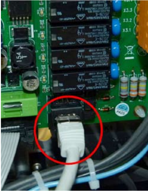
Obr. 1 - Konektor sériové linky RS 485 na zdroji
