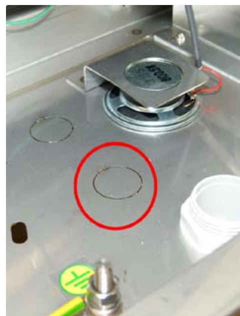
Obr. 4: Otvor pro montáž průchodky s kabelem UTP
